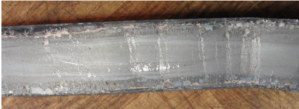
11. ábra: A kísérleti lecsévélővel lecsévélte törésvonalas kísérleti lemezcsík
