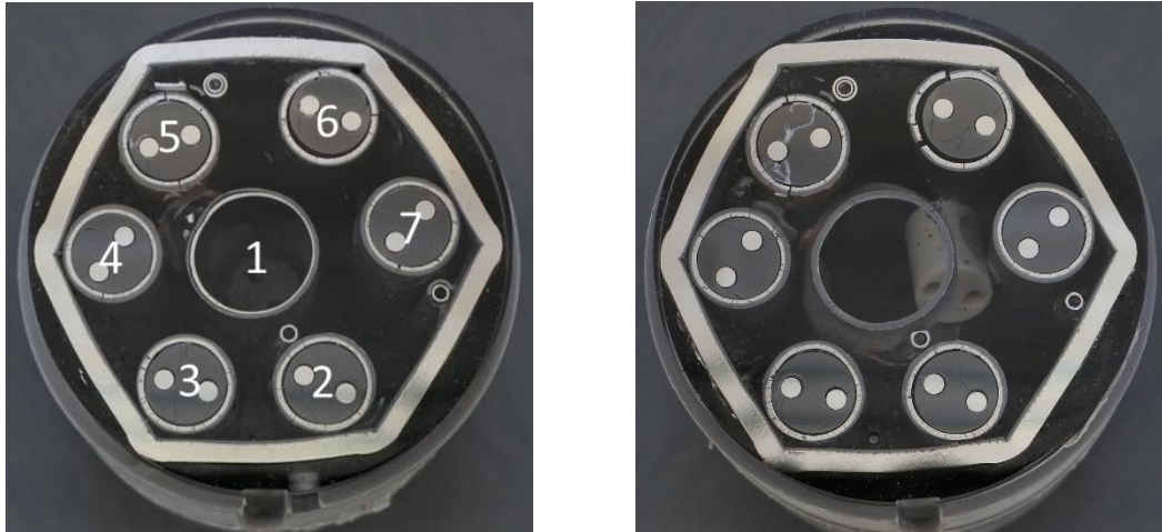
76. ábra: A CODEX-SBO köteg vízszintes metszete 550 mm magasságban (alsó és felső metszet).
