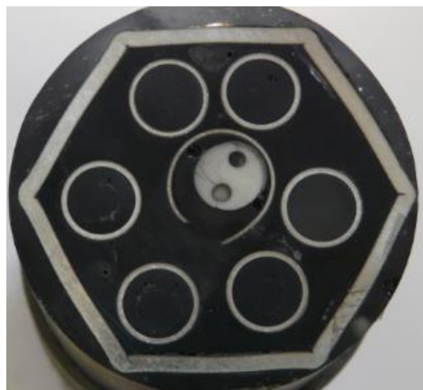
48. ábra: A CODEX-AIT-3 kísérlet kötegeének keresztmetszete 900 mm magasságban a felhasadt középső rúddal
