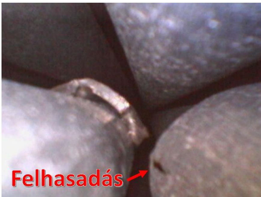
82. ábra: Endoszkópos felvétel a köteg belsejében, a felhasadt burkolatról
