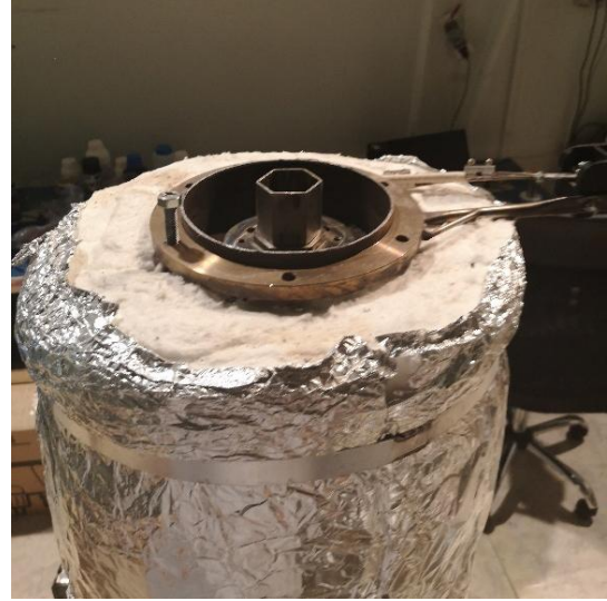
11. ábra: A kazettafal szigetelése (balra) és köpeny a külső szigeteléssel és a köpenyfűtéssel (jobbra)
