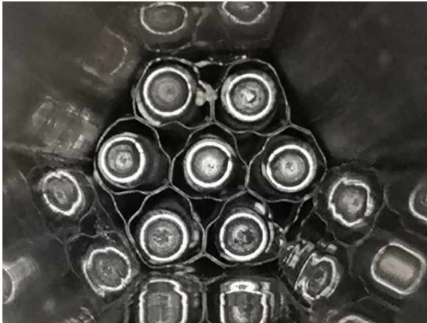
81. ábra: Endoszkópos felvétel a CODEX-SLIM köteg felső részéről
