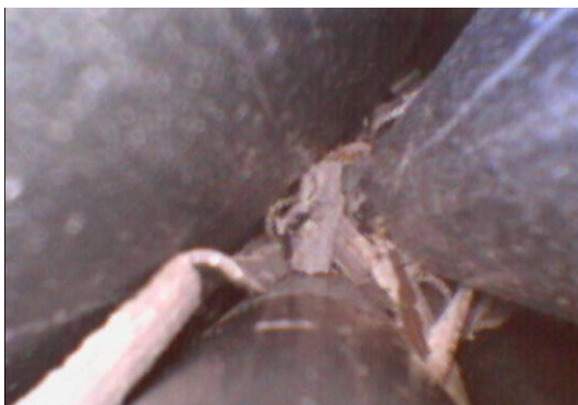
72. ábra: A CODEX-SBO köteg alsó távtartórácsán összegyűlt törmelék
