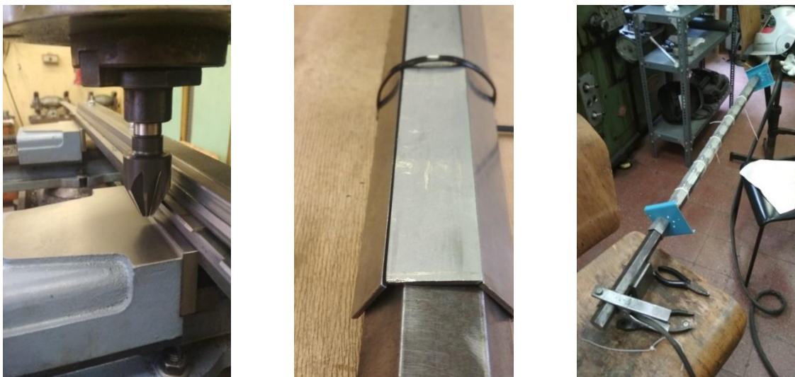
10. ábra: A kazettafal cirkóniumlemezeinek megmunkálása (marás, geometria összeállítás, hegesztés)
