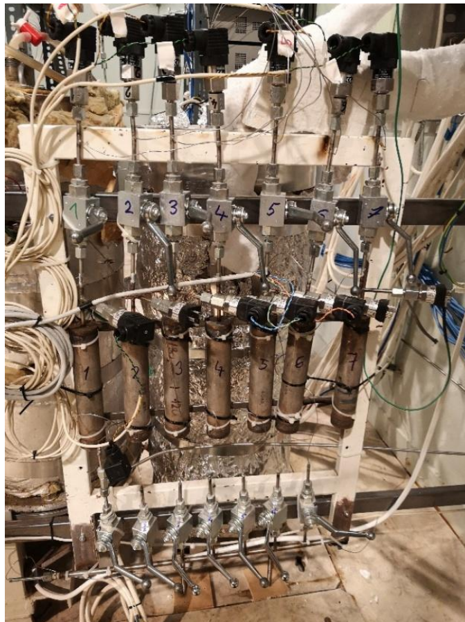
19. ábra: Az egyes pálcák nyomását vezérlő szelepek, puffertartályok és nyomástávadók
