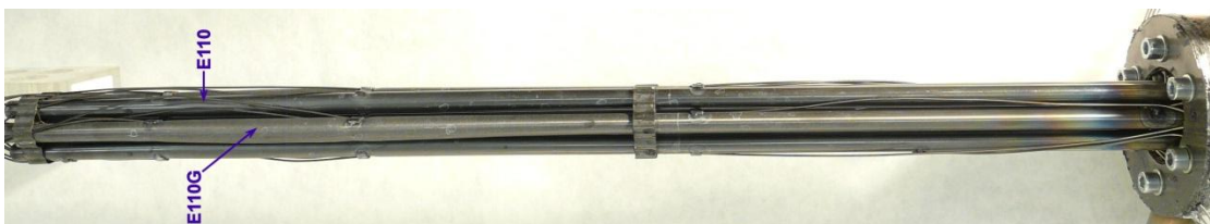
25. ábra: A teljes kísérleti köteg a CODEX-LOCA-200 kísérletet követően
