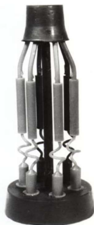
a) bokrosított viaszminta b) kerámia héjforma c) nyers öntvény IK után
