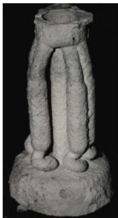
a) bokrosított viaszminta b) kerámia héjforma c) nyers öntvény IK után
