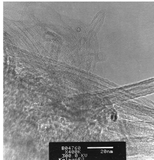
TEM of Carbon nanotubes
