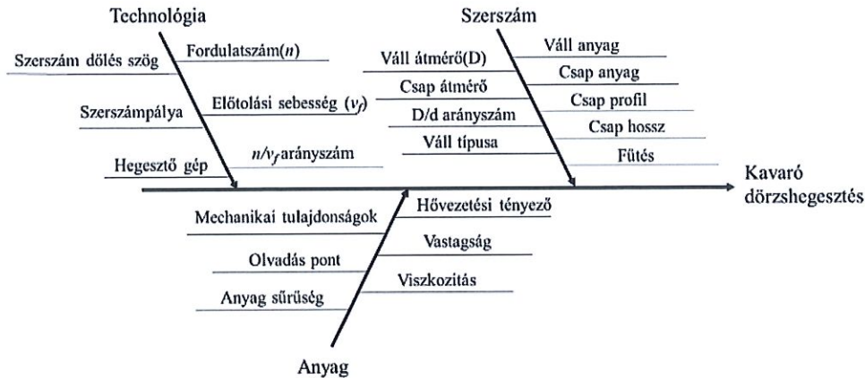
2.ábra. A kavaro dörzshegesztés folyamat paramétereit
