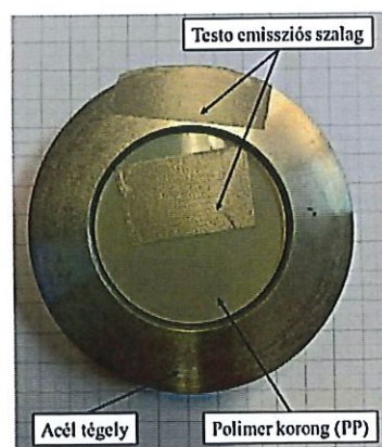
5. ábra: A mérések során használt acél tégely, polimer korong és emissziós szalag
