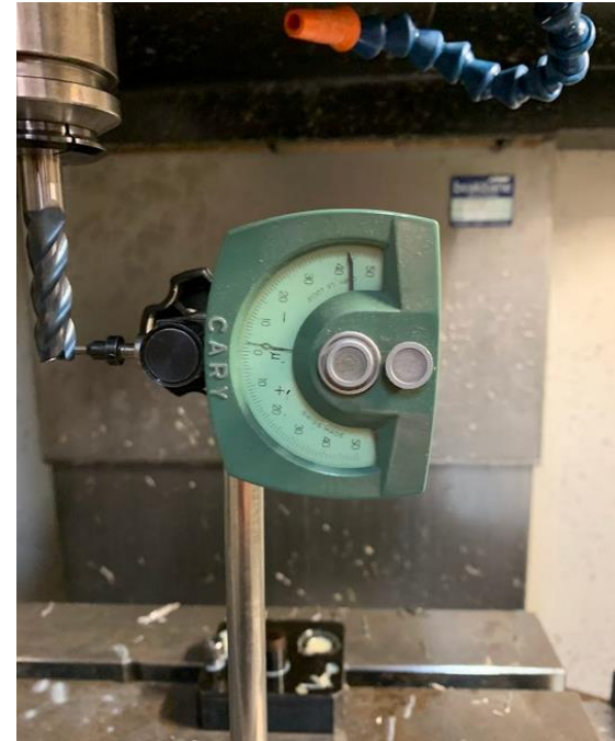
Szerszám fogainak radiális eltérés vizsgálata
