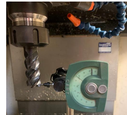
Szerszám fogainak radiális eltérés vizsgálata
