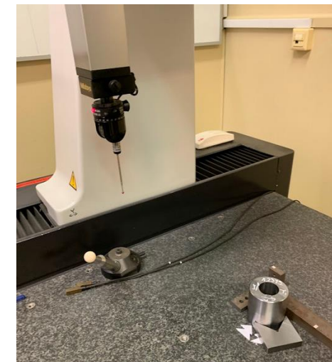
Munkadarab pontosságának vizsgálata koordinátamérő gépen
