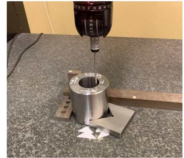
Munkadarab pontosságának vizsgálata koordinátamérő gépen
