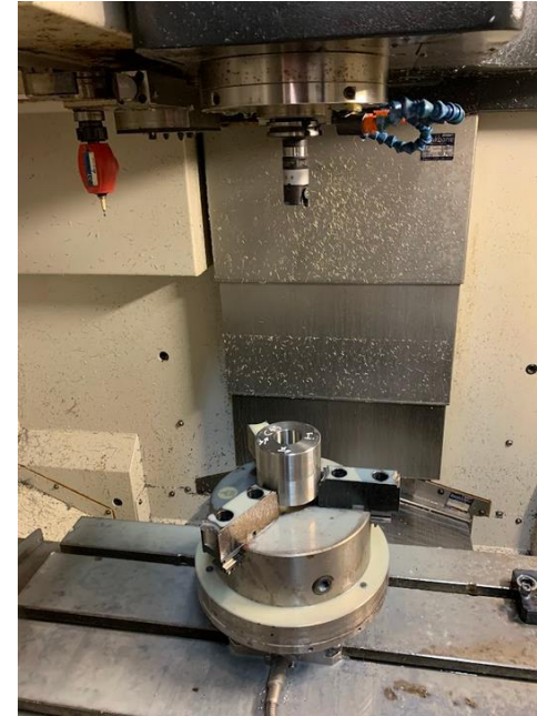
Kész munkadarab kiesztergálás után
