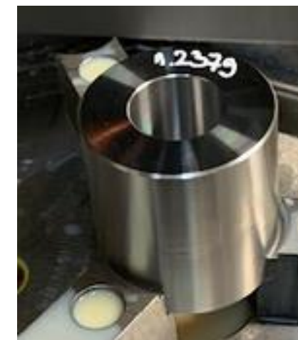
Kiesztergálással készített mdb
