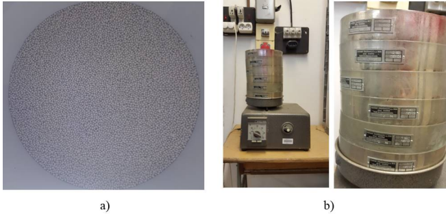
7. ábra: a) Homokkő szemcsék, b) Többlépcsős vibrációs rosta
