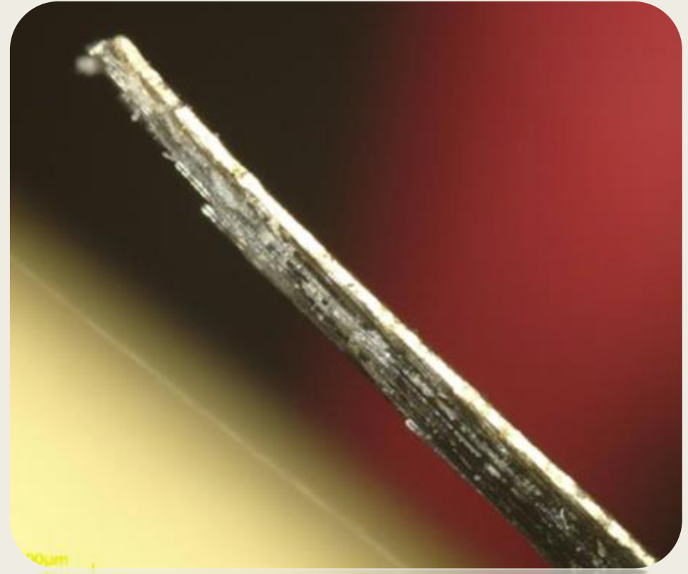
Az íj kar felhasadásának oldalnézeti mikroszkóp képe
