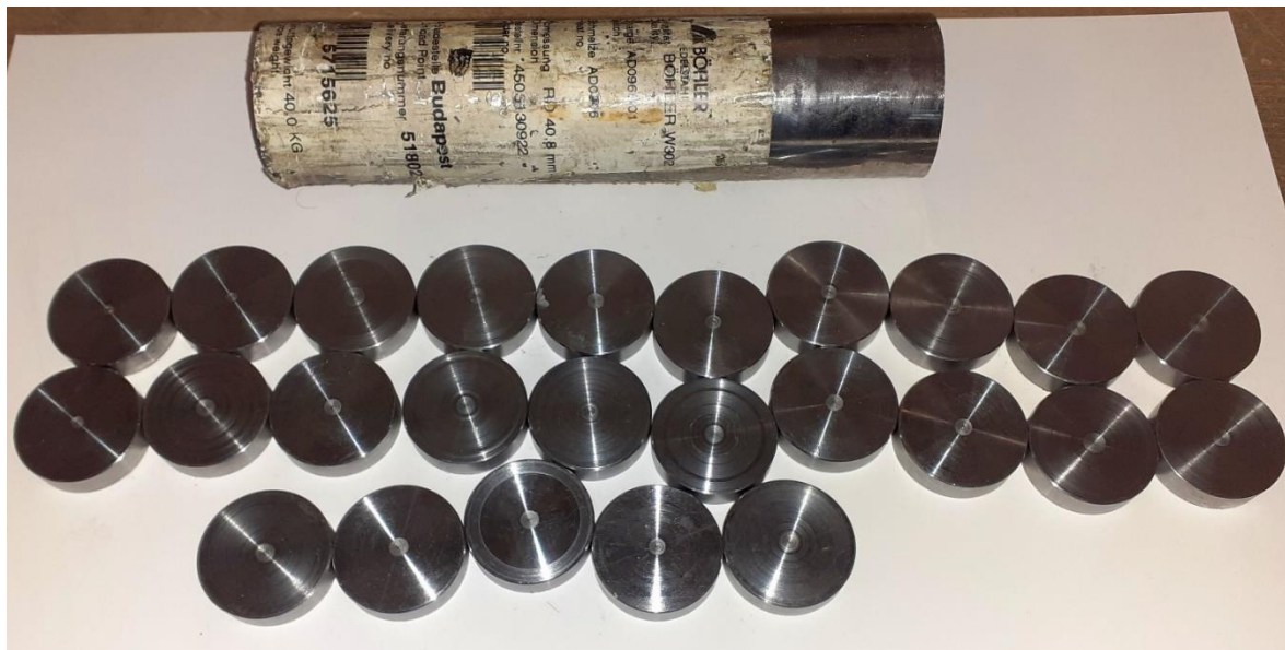
CNC esztergált próbatest előgyártmányok
