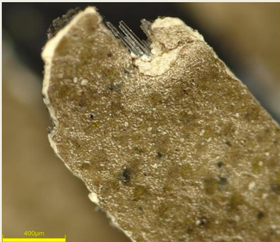
4. Ábra A felhasadt üvegszál felülnézeti mikroszkópos képe az íj karon
