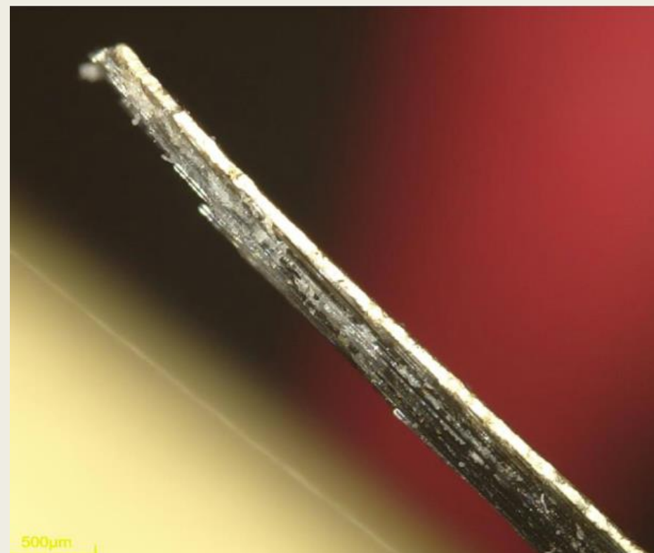
5. Ábra A felhasadt üvegszál oldalnézeti mikroszkópos képe az íj karon
