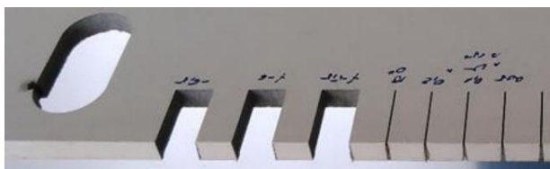
13. ábra: Szálcement próbatestek lézersugaras vágást követően.
