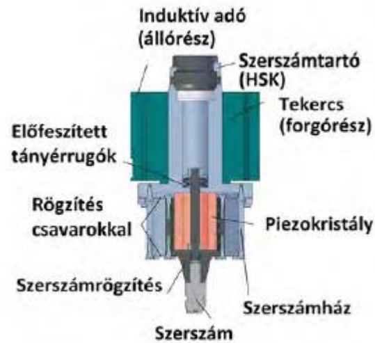
3. ábra. DMG – Sauer Ultrasonic technológia elvi vázlata [11]
