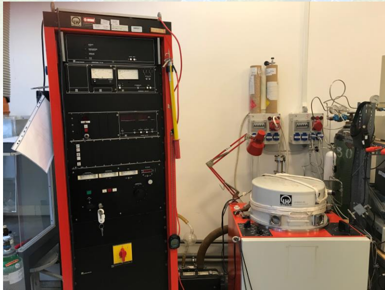
Leybold AG típusú rádiófrekvenciás porlasztó
